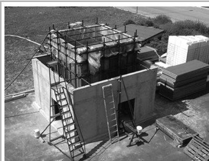
a) Prova di carico su innovativo sistema di orizzontamento
