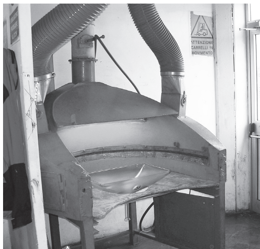
Fig. 1.2 – Un esempio di prevenzione primaria: un banco aspirato utilizzato per la captazione alla fonte delle polveri immesse nell'ambiente nel corso della lavorazione
