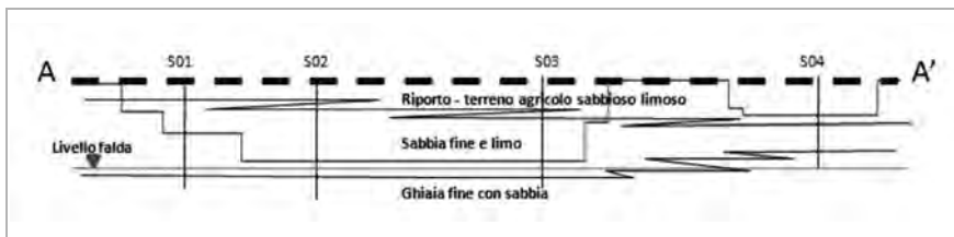
Figura 2.3 Profilo litologico di scavo
